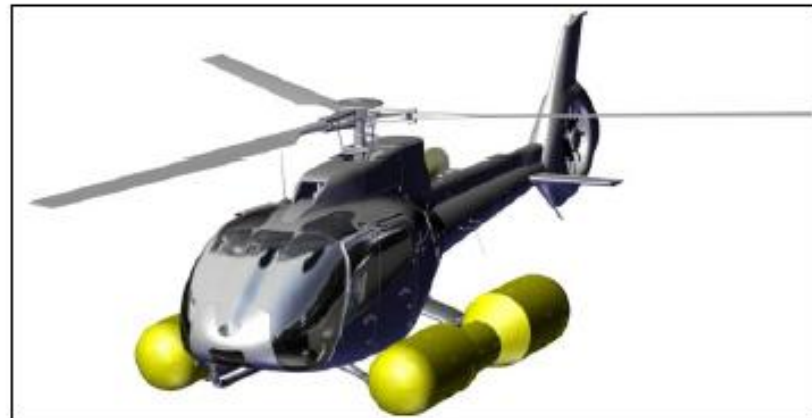
Figure 4 : dispositif de flottabilité de secours (Source : Airbus)
